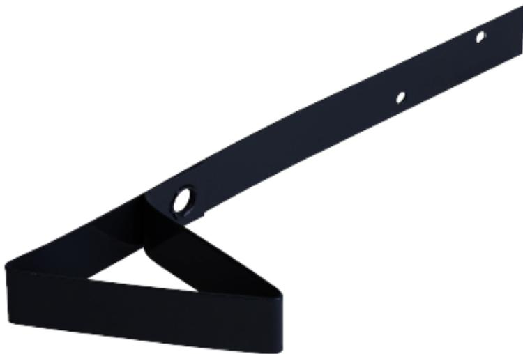
Снегозадержатели препятствуют лавинообразному сходу снега, предохраняют от повреждения водосточную систему, а также обеспечивают равномерную снеговую нагрузку на кровельную систему и дополнительную теплоизоляцию (уменьшают потери тепла). Представляют собой металлические уголки с цветным полимерным покрытием на длинной ножке, которые монтируются непосредственно в процессе укладки кровельного покрытия. Место крепления закрывается последующим рядом битумной кровли, чем обеспечивается
