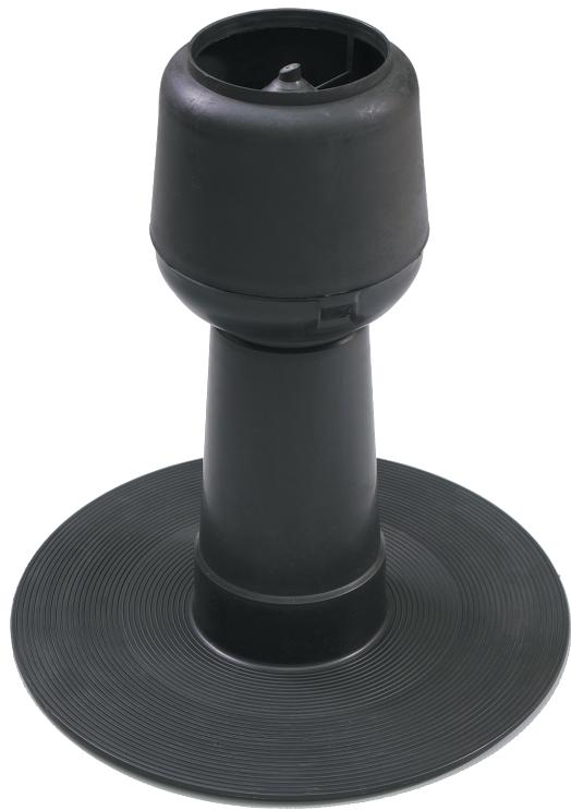
Аэраторы кровельные ТехноНИКОЛЬ 160x460 мм и ТехноНИКОЛЬ ЭКО 160x450 мм позволяют эффективно удалять излишки влаги из кровельного пирога. Монтаж аэраторов при устройстве или ремонте совмещенной кровли дополнительно увеличивает эффективность минераловатной теплоизоляции, за счет снижения ее влажности. В системах с механическим креплением кровельного ковра к основанию рекомендуется устанавливать один аэратор на 150 м<sup>2</sup> кровли. Наиболее
