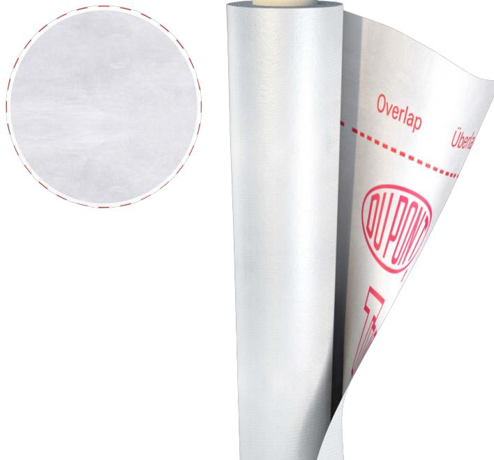
Tyvek® — это высокотехнологичный мембранный материал, производимый компанией DuPont, который сочетает в себе прочность, защитные свойства и высокую паропроницаемость. Он состоит из миллионов тонких непрерывных волокон полиэтилена низкого давления, полученных методом сверхскоростного формования и скрепленных под воздействием температур. Уникальная нетканая структура материала обеспечивает паропроницаемость и, одновременно, защитные свойства по всей
